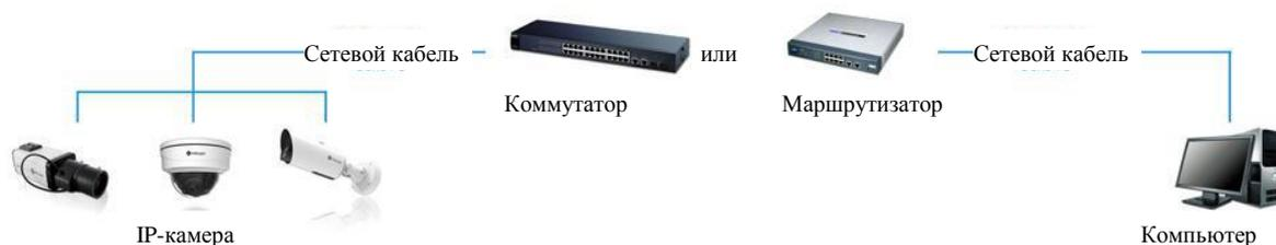
Рисунок 2-1-2 Подключение через коммутатор или маршрутизатор
